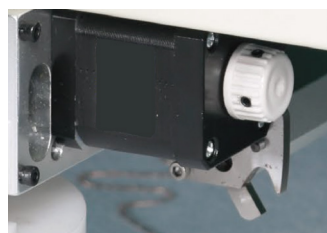
【选配】自动剪碳纤维功能，实现自动剪切。 Optional: Automatic cutting to enable automated cutting of carbon fiber.
